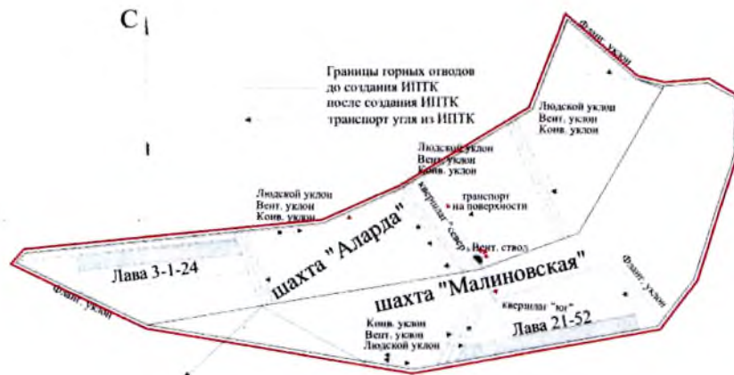
Рис. 23. Пример интегрированного подземного технологического комплекса на базе шахт «Алардинская» и «Малиновская»
